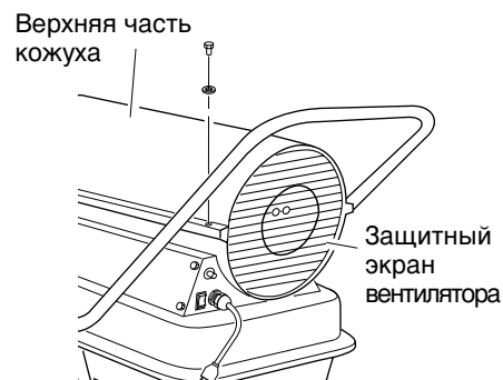
Рис. 8. Снятие верхней части кожуха, нагреватели мощностью 29 и 44 кВт
