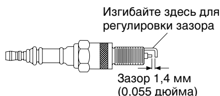
Рис. 12. Регулировка зазора свечи зажигания, нагреватель мощностью 10 кВт
