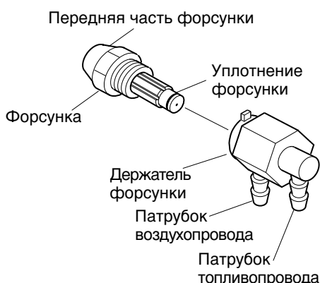
Рис. 22. Форсунка и держатель форсунки, нагреватель мощностью 10 кВт
